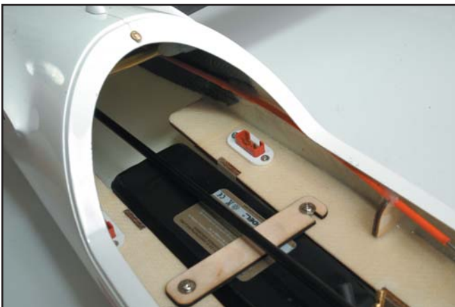
Le pack de propulsion 4000mAh 4S1P en place.
