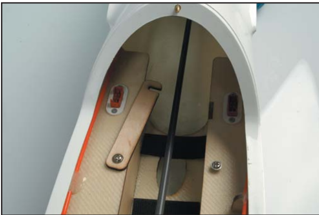
La commande de volet, vue de dessus, parfaitement intégrée et quasiment invisible.
